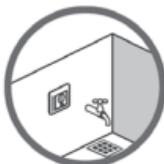
Во влажных помещениях следует устанавливать в строгом соответствии с действующими нормами ПУЭ (Правила устройства электроустановок), ПБЕ (Правила будови електроустановок), СНиП (Строительные нормы и правила) и ДБН (Державні будівельні норми). В большинстве случаев устанавливается вне влажных помещений.
